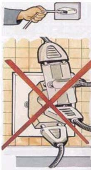
Utilización incorrecta de una toma
